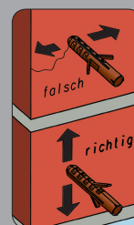
Let op hoe de vleugels van de plug staan tijdens het inslaan.
